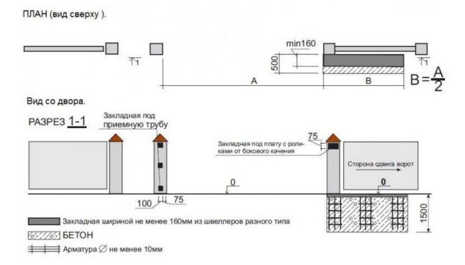
В стороне для отката ворот, параллельно забору со стороны двора, надо вырыть траншею. Ее длинна- это 1/2 ширины проема (например, при проеме 4 метра длина ямы = 2 метра), ширина траншеи примерно 50 см. (если получится сделать уже - на качество это не повлияет, а бетон
