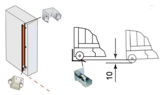
Внимание! Устанавливать ловушки нужно после того, как полотно полностью готово (нагружено). В противном случае потребуется корректировка их положения после отделки ворот.
