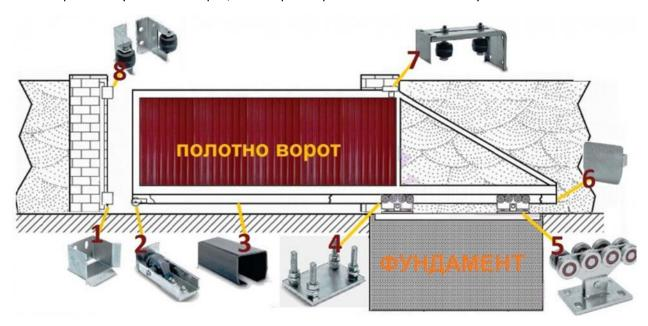
Полотно ворот изготовлено из профильных труб и по длине примерно в 1,5 шире, чем проем. Его можно условно разбить на две конструктивные части: основную, которая заслоняет собой проем и в последующем подлежит отделке (например профнастилом, деревом) и консольную,
