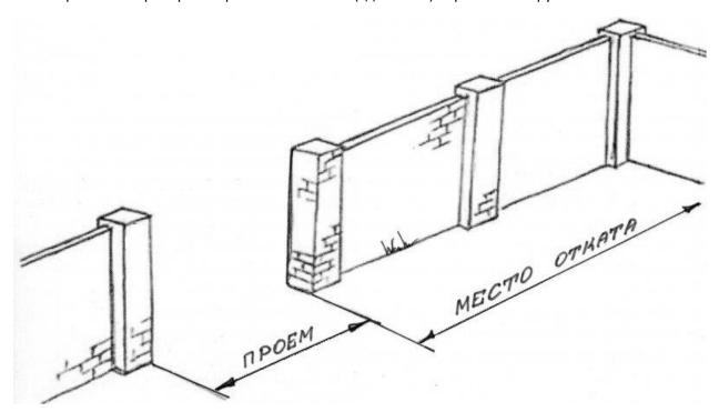
Для правильного расчета длины конструкции нужно произвести замер исходных данных. Полотно ворот может быть произведено для имеющегося проема или может проектироваться одновременно с забором. Предположим, что забор уже установлен и у нас есть проем, который необходимо закрыть. Проем ограничен столбами.
