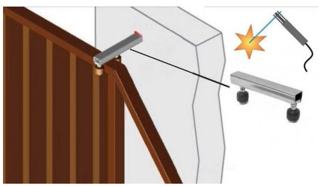
Приварить верхний ограничитель створки к столбу, за который откатывается полотно. Отрегулировать положение полотна и зазор между створкой ворот и роликами от боковых качений. Затянуть крепление роликов.
